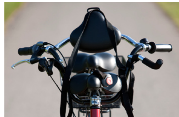
Formidables Fahrvergnügen in luftiger Höhe: Der Tangaroo-Sitz besteht aus Sattel, Rückenlehne und Haltegriffen mit Hebel für die 6-Gang-Kettenschaltung.
